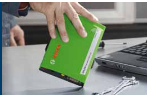
Moduł KTS Bosch do diagnozy sterowników
