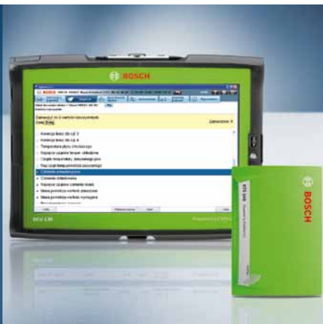
KTS 840: kombinacja DCU 130 i KTS 540
