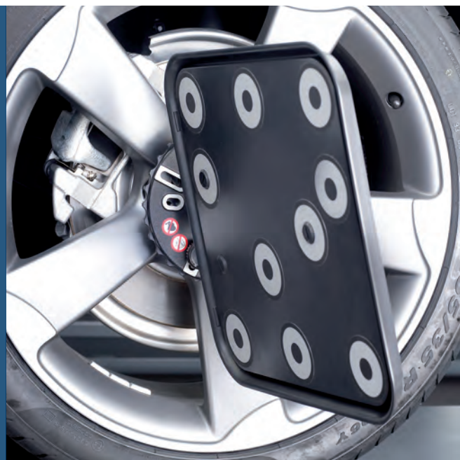
Zacisk magnetyczny: szybkie mocowanie bezpośrednio do śrub koła
